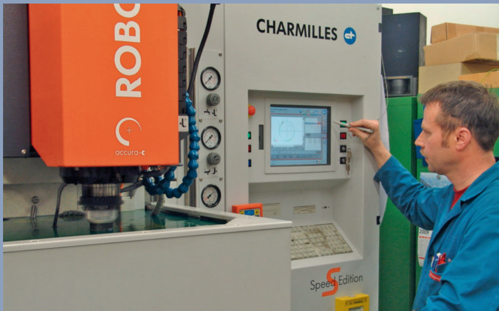
Bruno Spiess, Leiter Funkenerosion und stellvertretender Leiter Werkzeugbau bei Victorinox, prüft an der Agie-Charmilles-Funkenerosionsmaschine die vom Netzwerkservers übertragenen Einstellwerte für den Radius, welche zuvor am CAD/CAM-Arbeitsplatz programmiert wurden. (Bild: M. Frutig)
